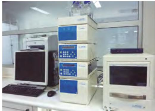
Lector de fluorescencia para microplacas y HPLC-PDA.
