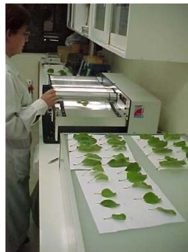
Foto 3. Determinación del área foliar utilizando un equipo LiCor LI 3100.
