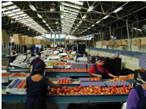
Foto 3. Debido a los innumerables sitios de impactos, las líneas de embalaje pueden llegar a ser la principal fuente de daño por machucón para la fruta, si no son regularmente revisadas y calibradas.
