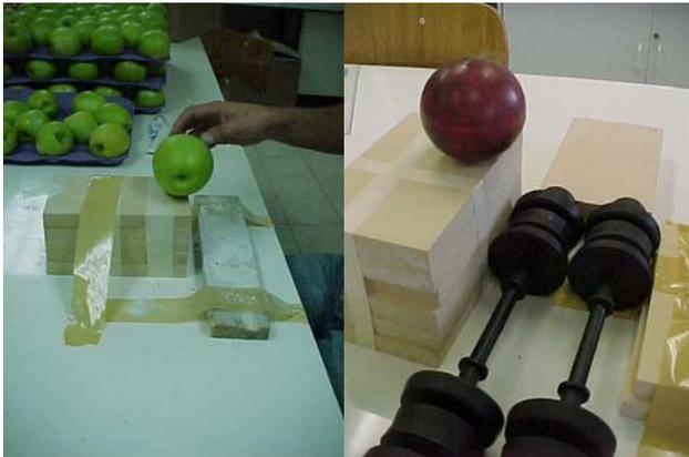
**Fotos 8 y 9.** Las pruebas de calibración del IS100 se realizan en laboratorio, dejando caer tanto el IS 100 como fruta, sobre materiales de diferente dureza, desde alturas variables.
