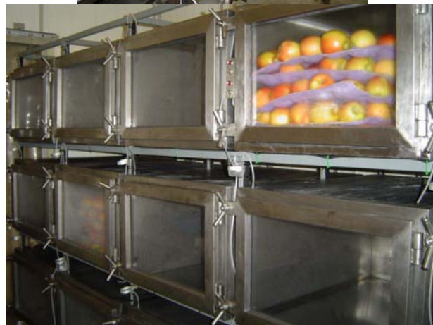
Foto 1. Catorce minicámaras de atmósfera controlada construidas en acero inoxidable fueron instaladas en el CP.
