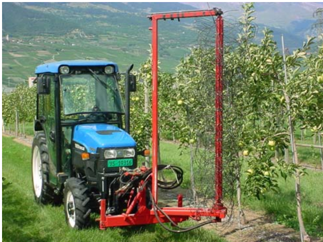
Foto 6. Equipo "Darwin" para raleo mecánico de fruta.
