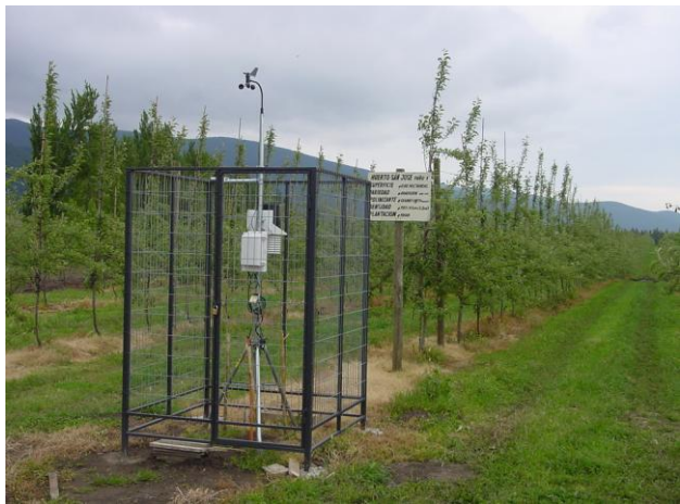
Foto 3: Estación meteorológica automática en el huerto módulo de Angol. Equipos similares se instalaron en el resto de los HM.
