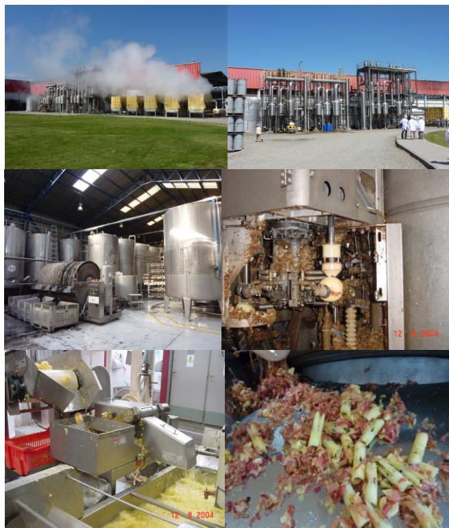
Foto 3. Planta elaboradora de jugos concentrados de manzanas; etapas en el proceso de producción de deshidratados; desechos que podrían emplearse para la generación de nuevos productos.
