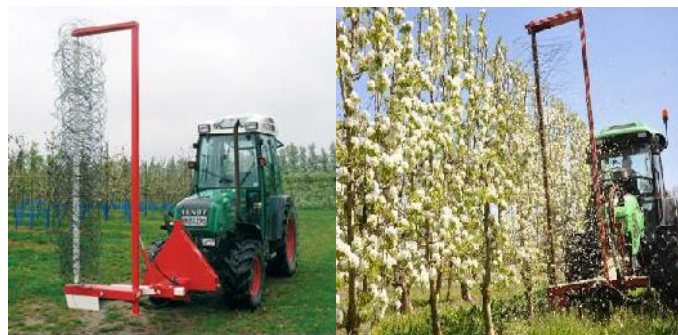
Foto 3. Máquina "Darwin" para el raleo mecánico de flores y frutos.
