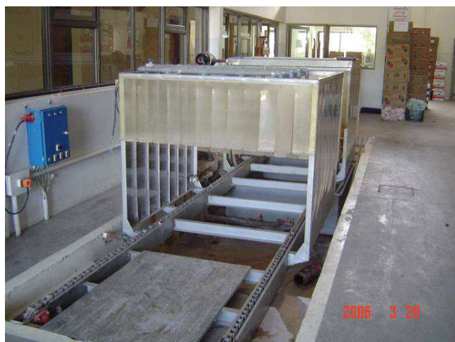
Foto 4. Instalaciones para tratamientos de fruta mediante drenching. INTA Alto Valle, Argentina.
