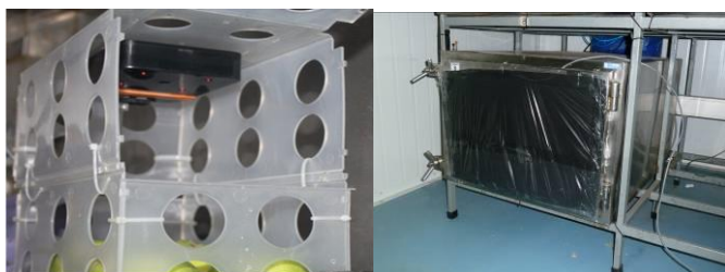
Foto 3. Sensor FIRM (Harvestwach) (izquierda) y mini-cámaras de atmósfera controlada (derecha) utilizados en los ensayos de ACD en el Centro de Pomáceas. Temporada 2010/11.
