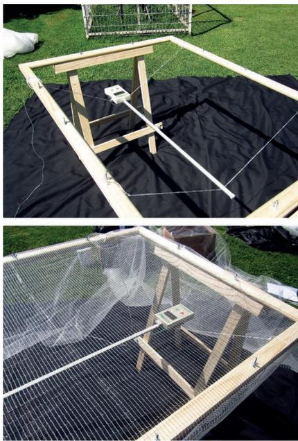
Foto 1. Sistema para medición de la transmisión de radiación solar de cobertores usados en fruticultura (Fuente: A. Sepúlveda).
