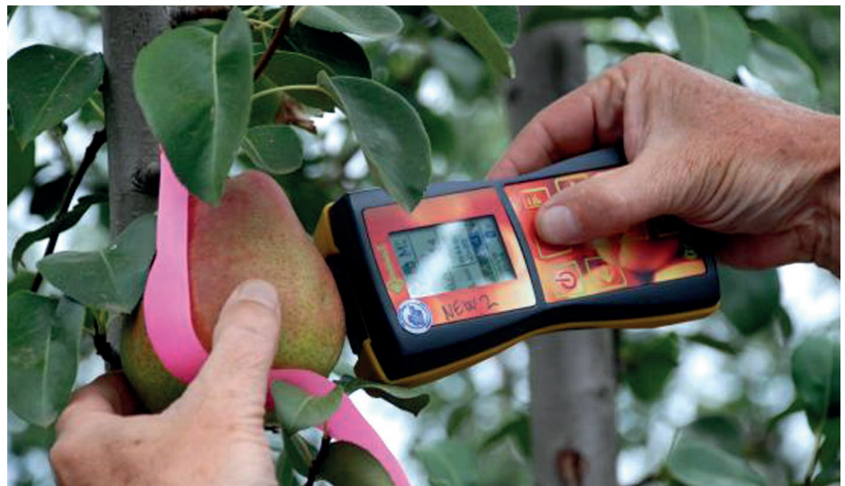
Foto 1. Evaluación de DA-Meter en peras. (Fuente: www.hin.au).
