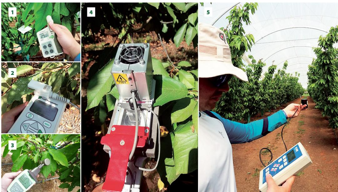
**Figura 4.** Algunos equipos utilizados para las mediciones ecofisiológicas y caracterización del microambiente: (1) SPAD; (2) Porómetro; (3) Sensor óptico Dualex-4; (4) Medidor de fotosíntesis portátil y; (5) Radiómetro UV-B.
