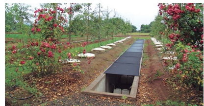
Lisímetro de drenaje. Estación Experimental Panguilemo. Facultad de Ciencias Agrarias - UTalca.
