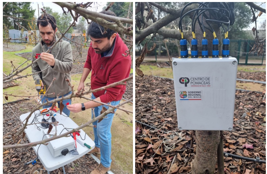
Foto 2. Instalación de sensores para medir y registrar la temperatura de la madera.
