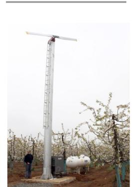
Existen variadas herramientas de protección para los cultivos frente a las adversidades climáticas. Una de ellas es el movimiento de aire a través de torres de viento, mezclando zonas con diferentes temperaturas para el caso de heladas por radiación.
