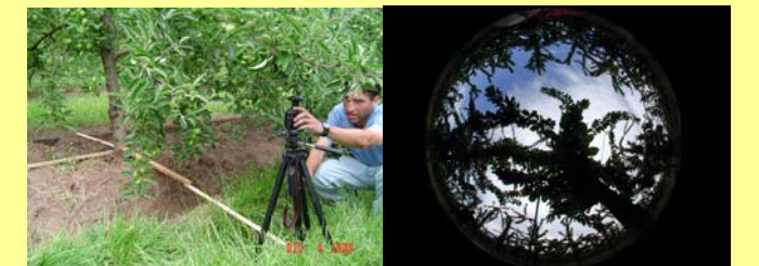
Foto 3. Fotografía hemisférica digital para la determinación de la cantidad de luz e IAF en frutales. Las fotografías captadas bajo la canopia son interpretadas con la ayuda de un software (HemiView).
