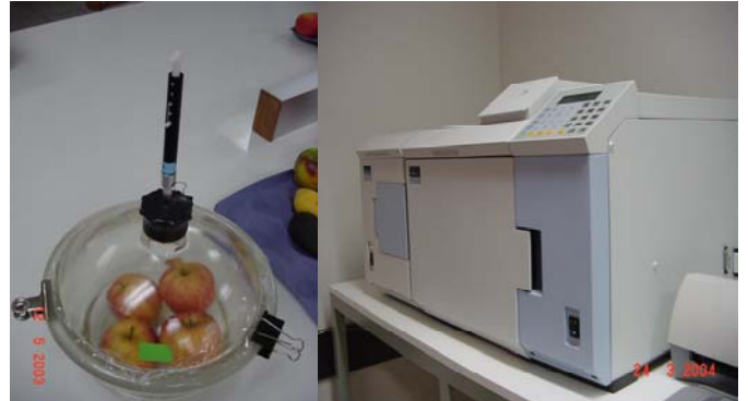
Foto 4. Campana de respiración con fibra de SPME para la captura de aromas (izquierda) y GC-MS para su detección (derecha).
