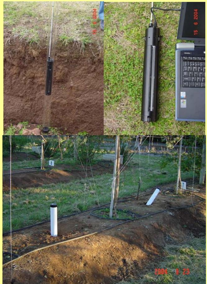
Foto 1. Scanner de Raíces con sus tubos de exploración, instalados en el Módulo Lisímetro de Drenaje y en San Clemente (Módulo 2).
