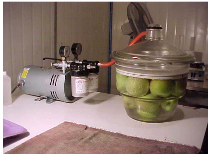
Foto 4. Infiltración de manzanas al vacío sumergidas en una solución que contiene MgCl_2 (IFMg).
