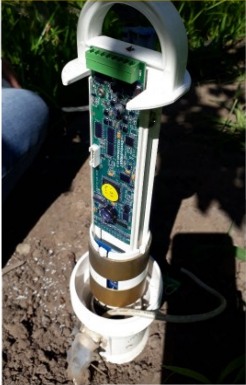
Sensores FDR con telemetría, seguimiento en tiempo real para definir estrategia de riego
