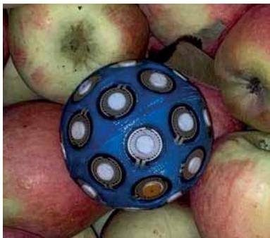
**Foto 3.** Medidor de compresión con 30 sensores.
